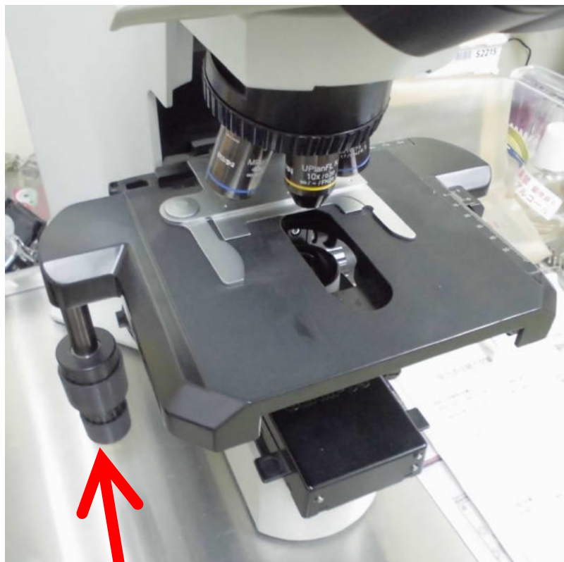
メカニカルステージのハンドル:スライドガラスを水平に動かし視野を変える
